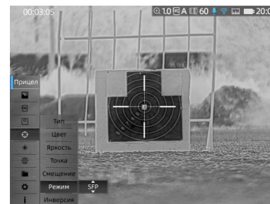
ВЫБОР РЕЖИМА ПРИЦЕЛЬНОЙ СЕТКИ (FFP ИЛИ SFP)
