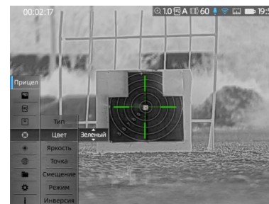
ВЫБОР ЦВЕТА ПРИЦЕЛЬНОЙ СЕТКИ. ДЛЯ ПРИМЕРА ВЫБРАН ЗЕЛЁНЫЙ ЦВЕТ
