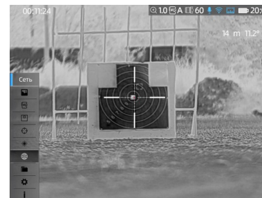
ЗАМЕР ДИСТАНЦИИ И УГЛА МЕСТА ЦЕЛИ. ДАННЫЕ ОТОБРАЖАЮТСЯ В ВЕРХНЕМ ПРАВOM УГЛУ, ПОД СТРОКОЙ СОСТОЯНИЯ
