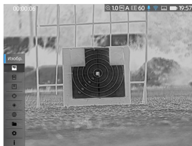
ПРИ ДВОЙНОМ НАЖАТИИ НА ДЖОЙСТИК НА ЛЕВОМ КРАЕ ДИСПЛЕЯ ПОЯВЛЯЕТСЯ КОЛОНКА ОСНОВНОГО МЕНЮ
